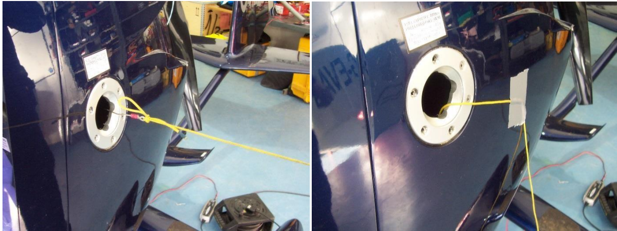
图 4+5:燃油加油口和接地编带安全绳
